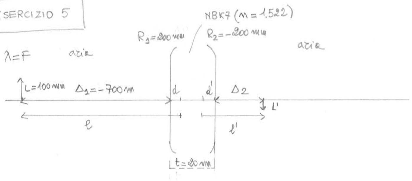
$$\begin{cases} R_2 = -R_1 \Rightarrow \text{le lente } \bar{e} \text{ EQUICONVESSA} \\ R_1 > 0 \end{cases}$$
