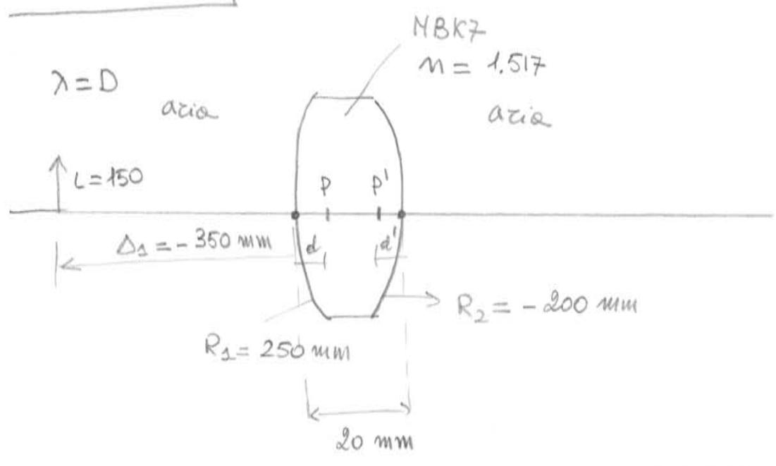
$R_1 > 0; R_2 < 0; |R_1| \neq |R_2| \Rightarrow$  LENTE BICONVEXA
